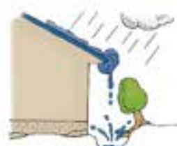
●軒下の地面が濡れて苔や藻類が繁殖し、外壁や庭木などを傷めます。
