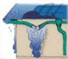
●雨漏りが、軒先・軒裏あるいは外壁にまわって腐食の原因になります。
