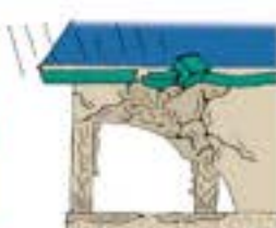
●モルタル壁などにクラックがあると、そこから雨水が壁の中に入り、柱や土台を腐食させます。
