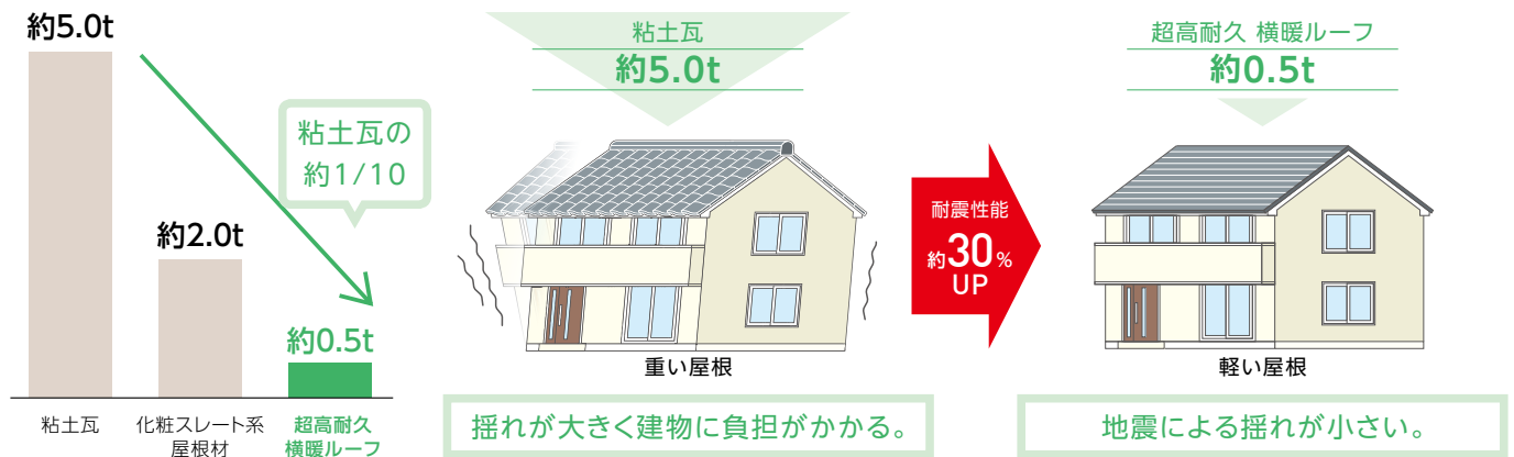
屋根材別重量比較(延べ床面積 50坪、屋根面積 100m 2 の2階建てを想定) ※当社計算値
