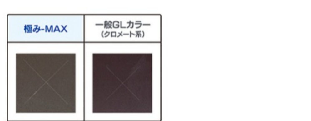
クロスカット部SST1500h後
